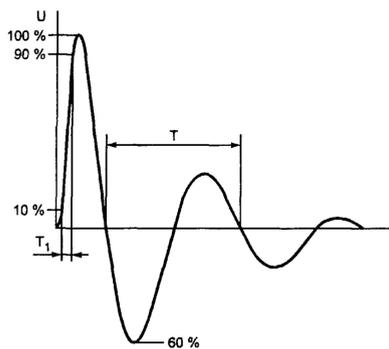
$T_1$  - время нарастания (0,5 мкс для напряжения в режиме холостого хода, 1 мкс для тока в режиме короткого замыкания); T - период колебаний (10 мкс)
