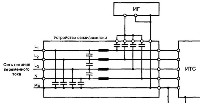
Рисунок 9. Испытания при воздействии на порт ввода-вывода [одна линия управления (сигнализации), подача помехи по схеме "провод-земля"]
