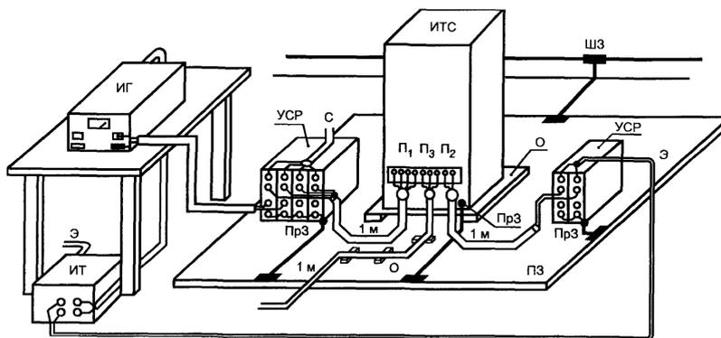
ШЗ - шина защитного заземления; Э - к сети электропитания;
