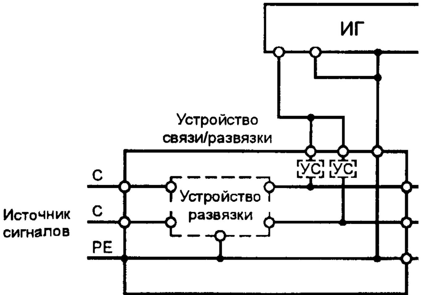
Рисунок 10. Испытания при воздействии на порт ввода-вывода [группа линий управления (сигнализации) с общим обратным проводником, подача помехи по схеме "провод-земля"]
