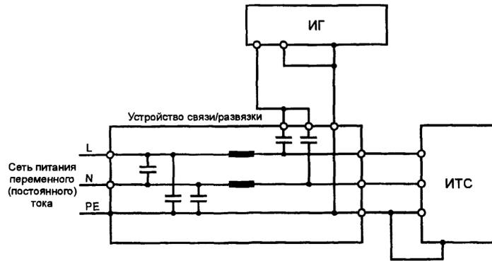
Рисунок 8. Испытания при воздействии на порт электропитания переменного тока (трехфазная электрическая сеть, подача помехи по схеме "провод-земля")
