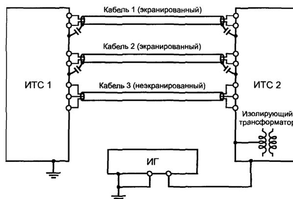
При использовании кабелей, экран которых заземляется на одном конце кабеля, незаземленный конец экрана должен быть подключен к корпусу ИТС через конденсатор связи емкостью 0,5 мкФ. Стандартная длина кабелей при проведении испытаний такого рода должна составлять 10 м. Сигнальные кабели подключают в соответствии с технической документацией на ИТС, в том числе в части применения мер защиты от помех.
