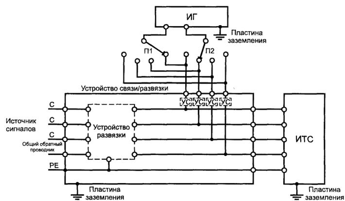
Рисунок 14б. Схема рабочего места с проводниками заземления (см. 7.1.2)
