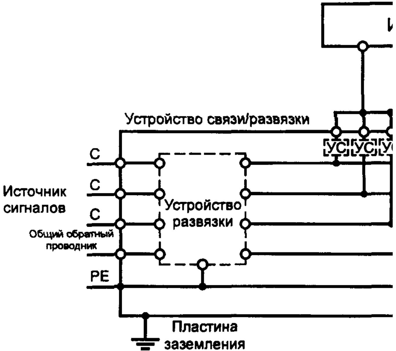
Рисунок 10б. Схема рабочего места с проводниками заземления (см. 7.1.2)
