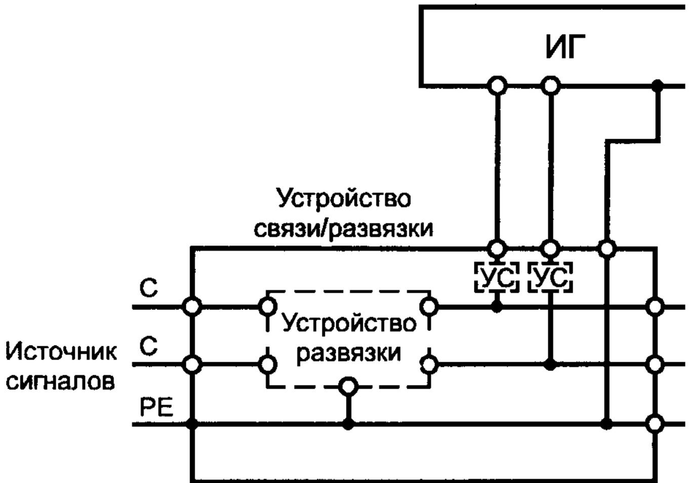
Рисунок 14. Испытания при воздействии на порт ввода-вывода [группа линий управления (сигнализации) с общим обратным проводником, подача помехи по схеме "провод-провод"]
