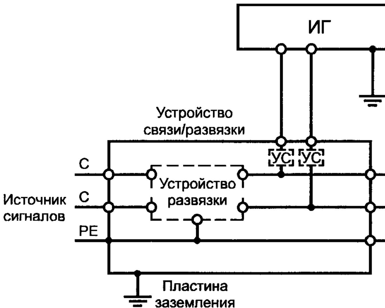
Рисунок 13б. Схема рабочего места с проводниками заземления (см. 7.1.2)
