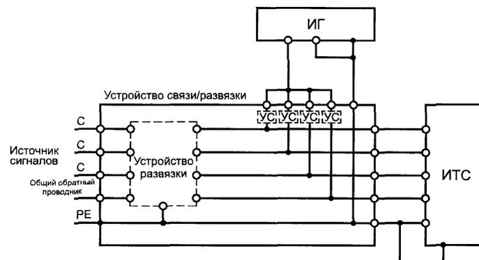
Рисунок 11. Испытания при воздействии на порт электропитания переменного/постоянного тока (однофазная электрическая сеть, подача помехи по схеме "провод-провод")
