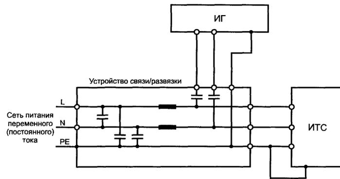
Рисунок 12. Испытания при воздействии на порт электропитания переменного тока (трехфазная электрическая сеть, подача помехи по схеме "провод-провод")
