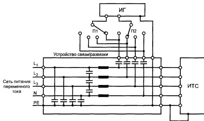
Рисунок 13. Испытания при воздействии на порт ввода-вывода [одна линия управления (сигнализации), подача помехи по схеме "провод-провод"]
