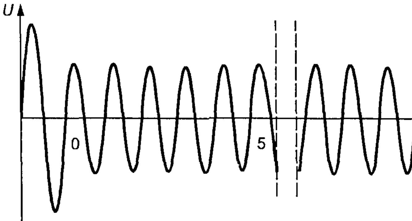
Примечание. Напряжение понижается до 70%  $U_T$  в течение 25 периодов при переходе через нуль.
