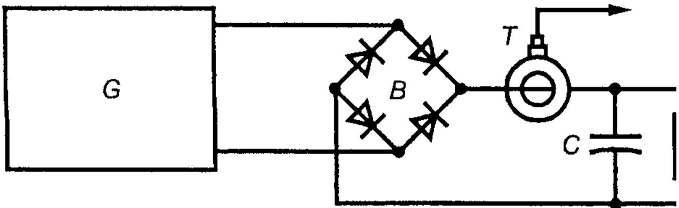
**G** - испытательный генератор провалов напряжения с переключением при  $90^\circ$  и  $270^\circ$ ; **T** - токосъемник; **B** - выпрямительный мост; **R** - резистор сопротивлением не более 10 кОм и не менее 100 Ом; **C** - электролитический конденсатор емкостью 1700 мкФ +/- 20%
