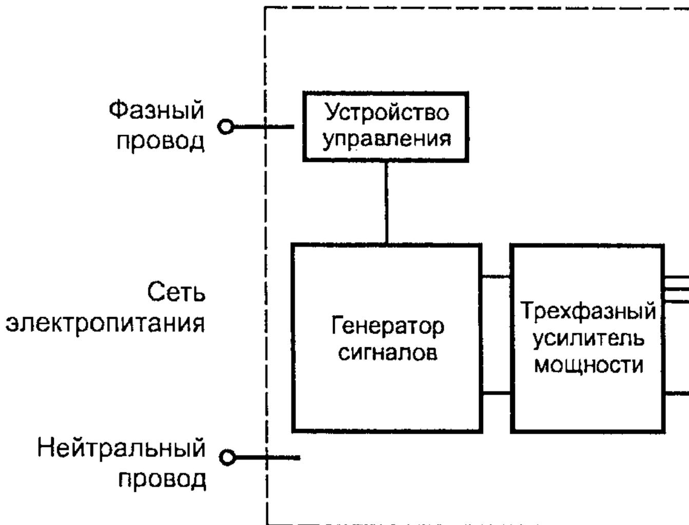
**Рисунок Г.3. Пример устройства ИГ для испытаний трехфазных систем при воздействии провалов, кратковременных прерываний и изменений напряжения с использованием генератора сигналов и усилителя мощности**
