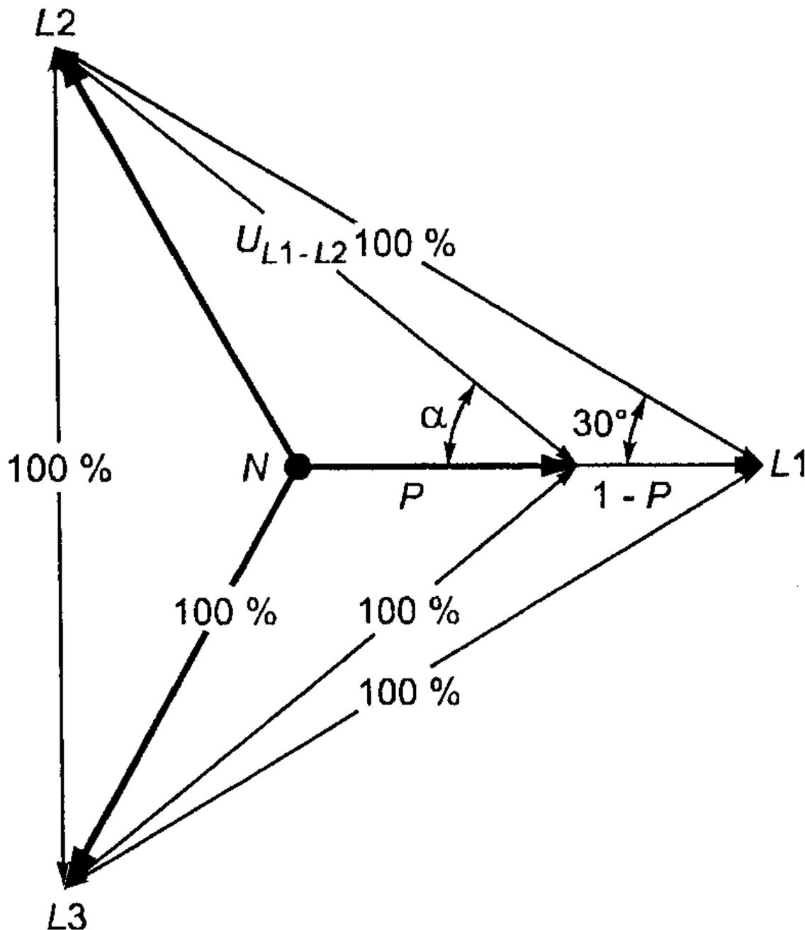
L1, L2, L3 - фазные провода; N - нейтральный провод; P - напряжение при провале "фаза-нейтраль", выраженное в долях номинального напряжения "фаза-нейтраль" (см. 3.4);
