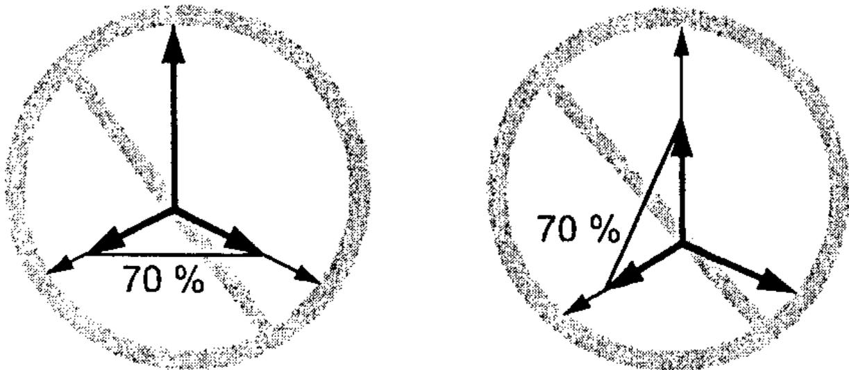
**г) Испытания "фаза-фаза" без фазового сдвига (неприемлемый метод)**
