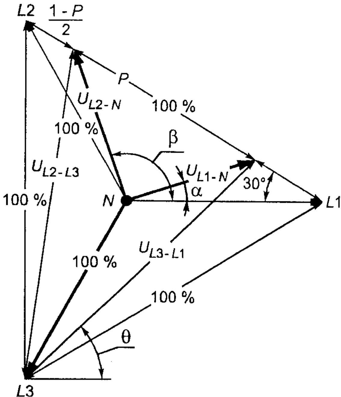
L1, L2, L3 - фазные провода; N - нейтральный провод; P - напряжение при провале "фаза-фаза", выраженное в долях номинального напряжения "фаза-фаза" (см. 3.4);
