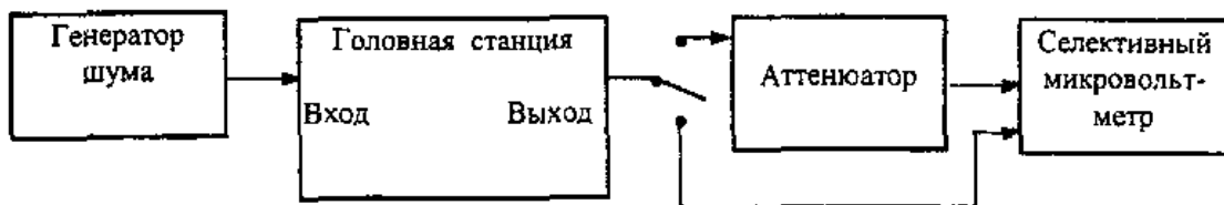
Рисунок 7.10. Структурная схема для измерения коэффициента шума
