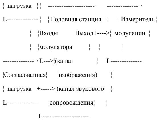
Рисунок 7.24. Структурная схема для определения отношения сигнала к фоновой помехе
