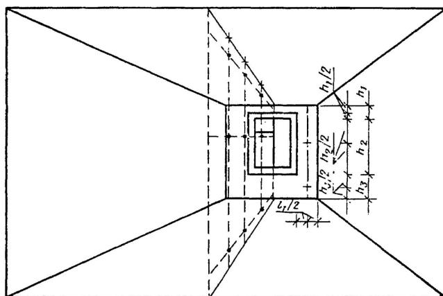
. - термопары в воздухе; + - термопары на поверхности
