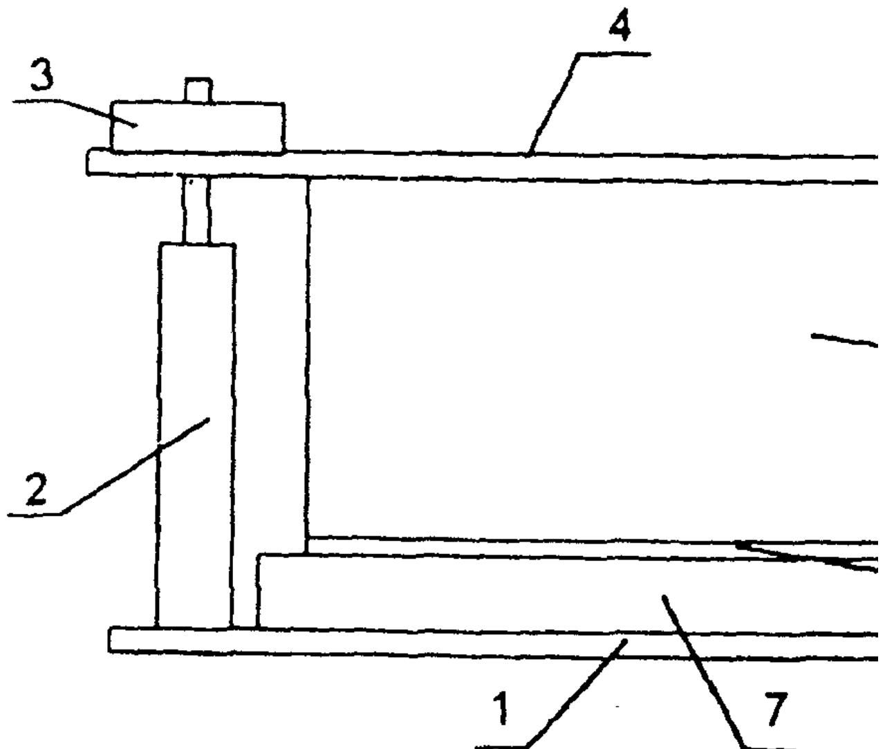
1 - основание; 2 - стойка; 3 - гайка; 4 - прижимная пластина; 5 - цилиндр; 6 - резиновое кольцо; 7 - образец
