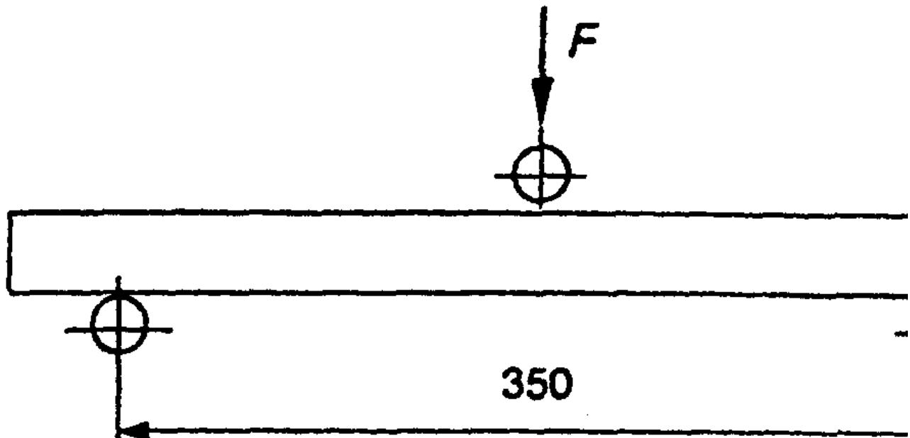
Рисунок 3. Схема испытания на прочность при изгибе
