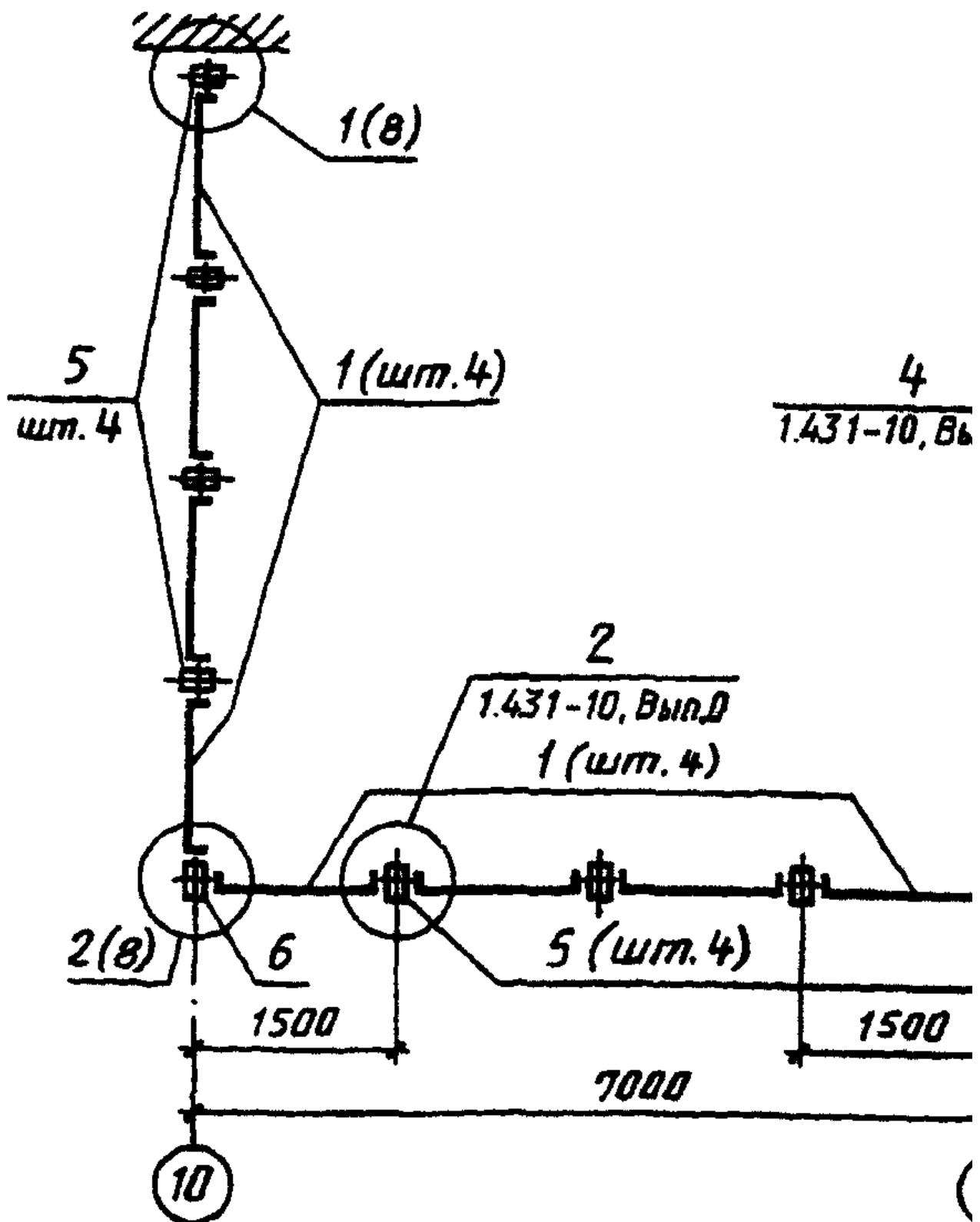
ПРИМЕР ВЫПОЛНЕНИЯ СХЕМЫ РАСПОЛОЖЕНИЯ ЭЛЕМЕНТОВ ЗАПОЛНЕНИЯ ОКОННОГО ПРОЕМА
