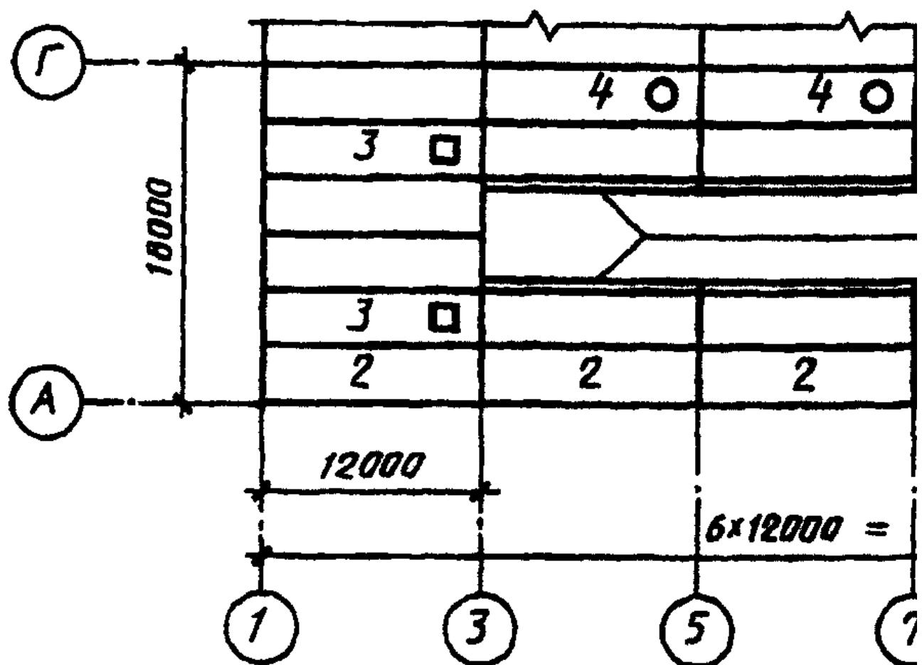
Схема расположения панелей стен
