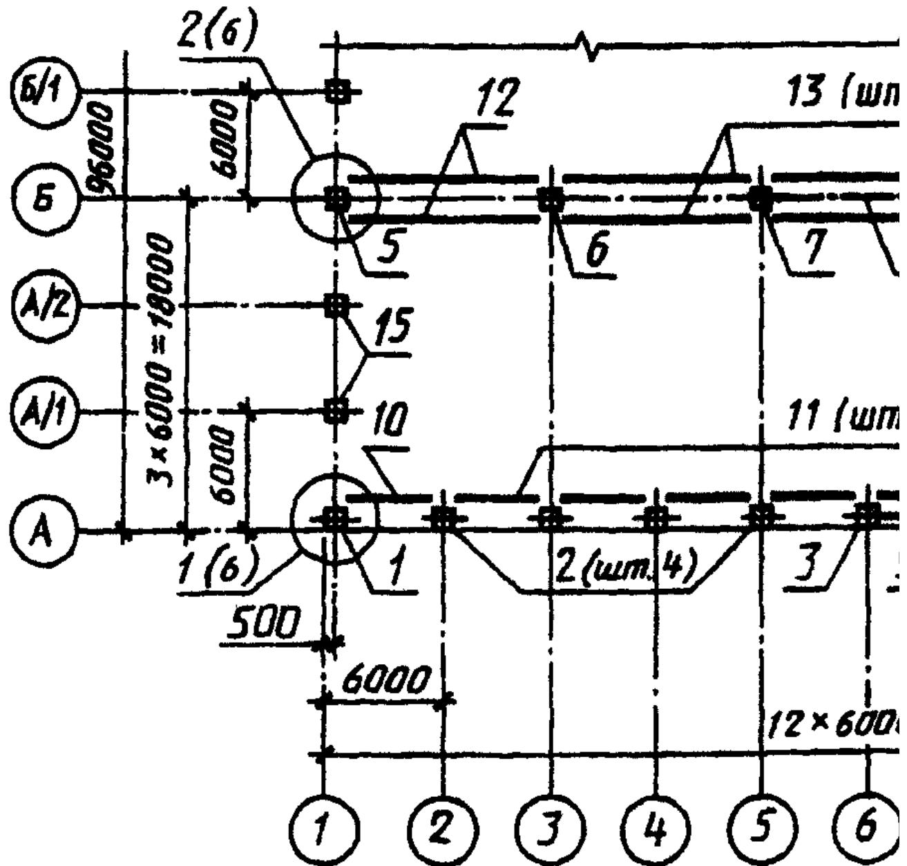
Схема расположения плит покрытия
