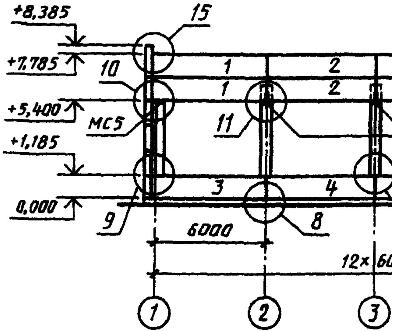
Схема расположения панелей стен, перегородок и других элементов жилого дома
