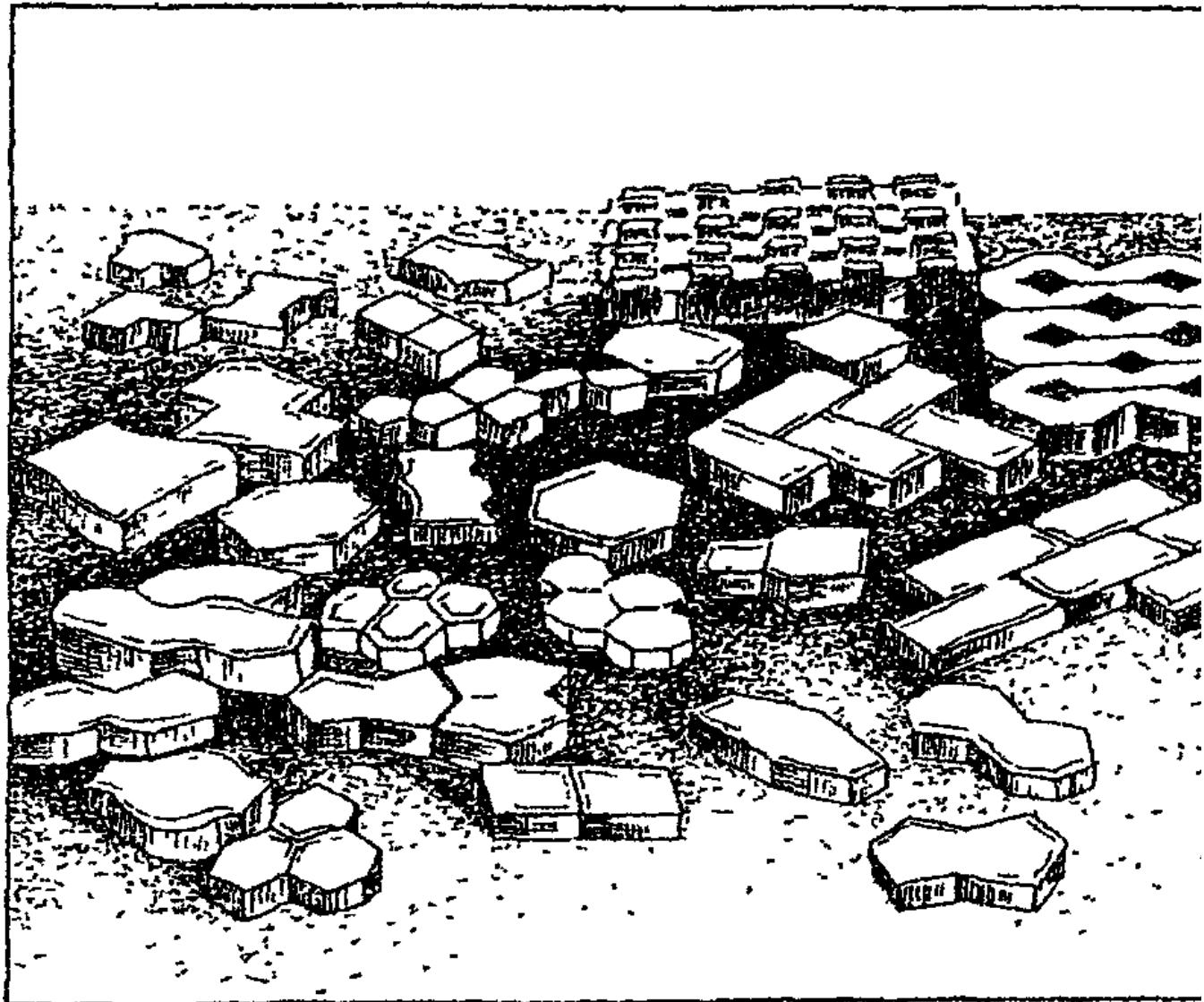
**Рис. 1.1. Общий вид фигурных плит и элементов мощения**
