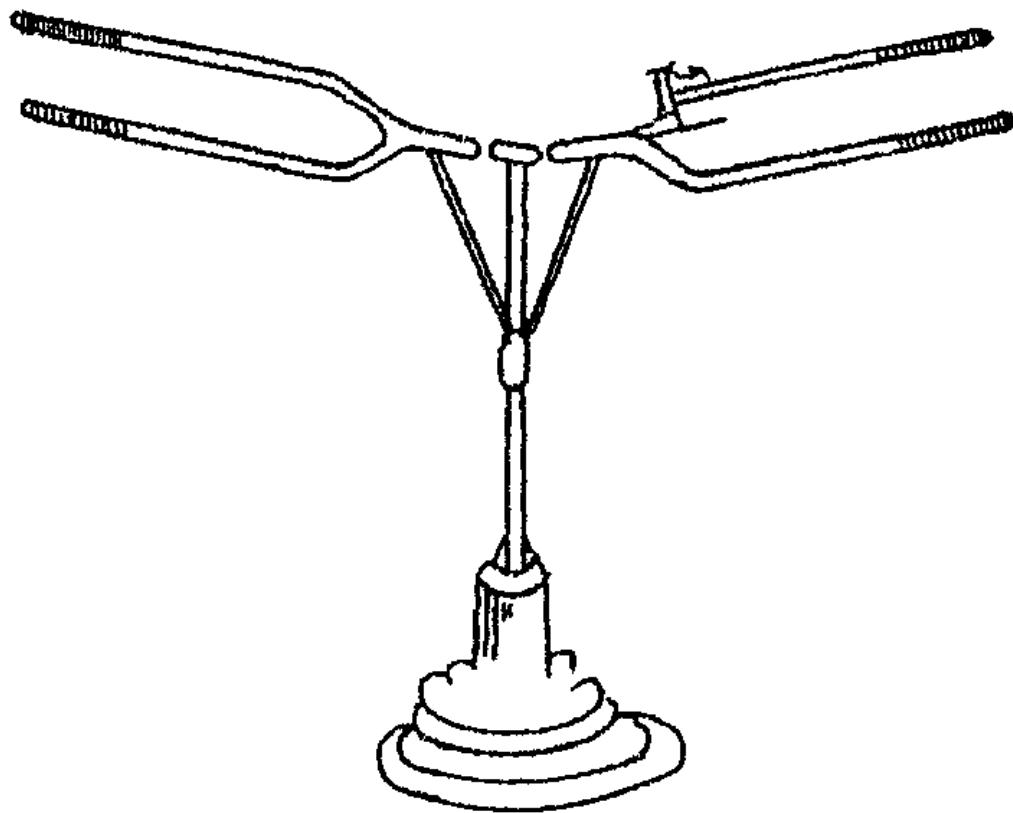
Рис. 3.2. Вакуум-захват для укладки плит
