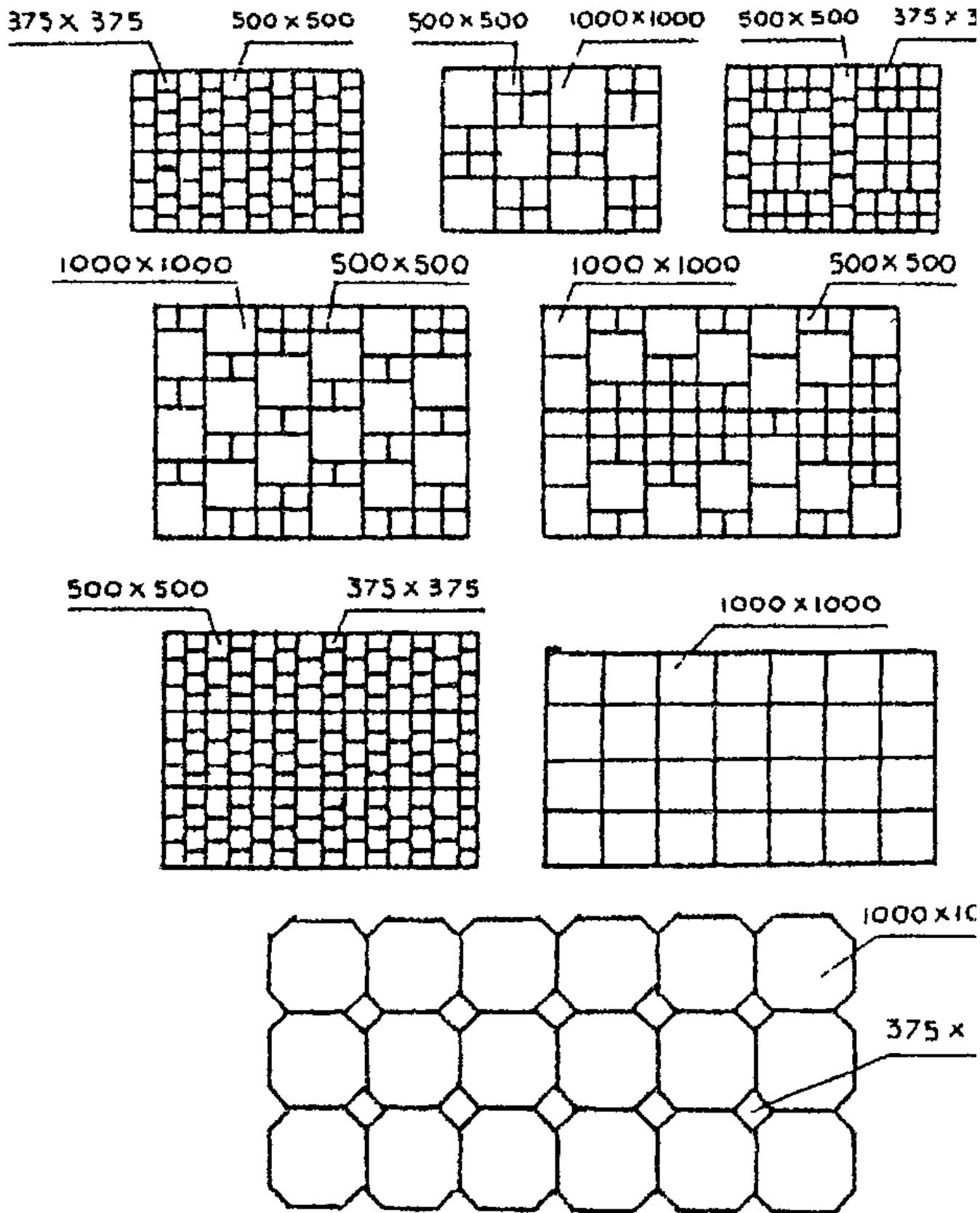
Рис. 3.3. Схемы раскладки плит в покрытии
