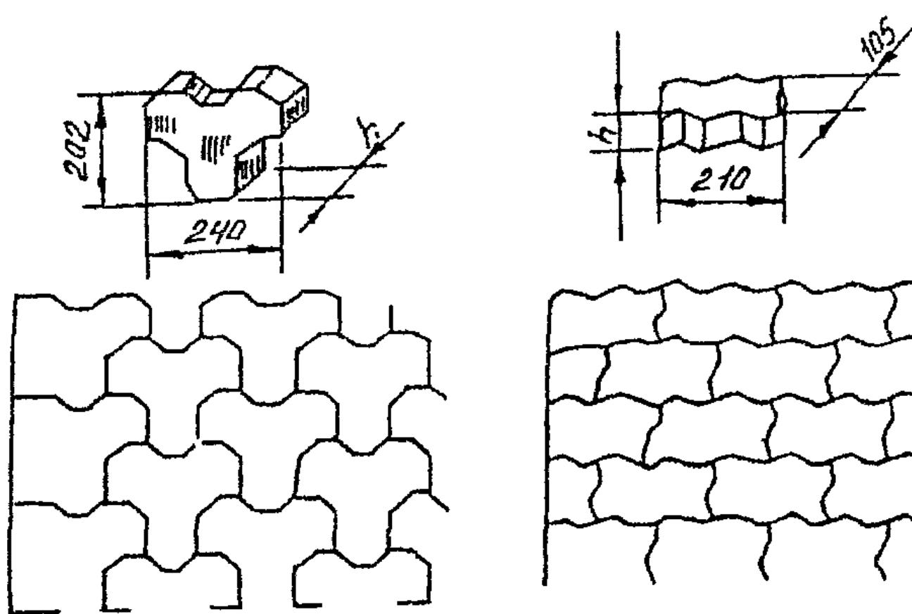
Рис. 3.6. Схемы раскладки фигурных элементов мощения
