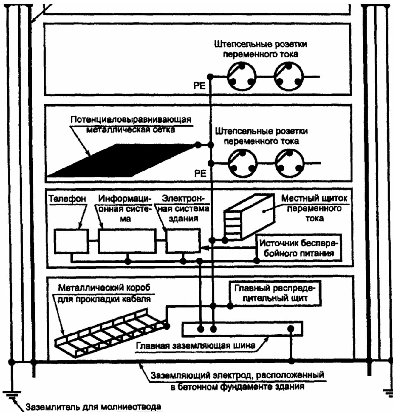
Рисунок 5. Общий вид системы заземления здания в соответствии с требованиями ГОСТ 50571.10, МЭК 1000-2-5 [1] и МЭК 1024-1 [3]
