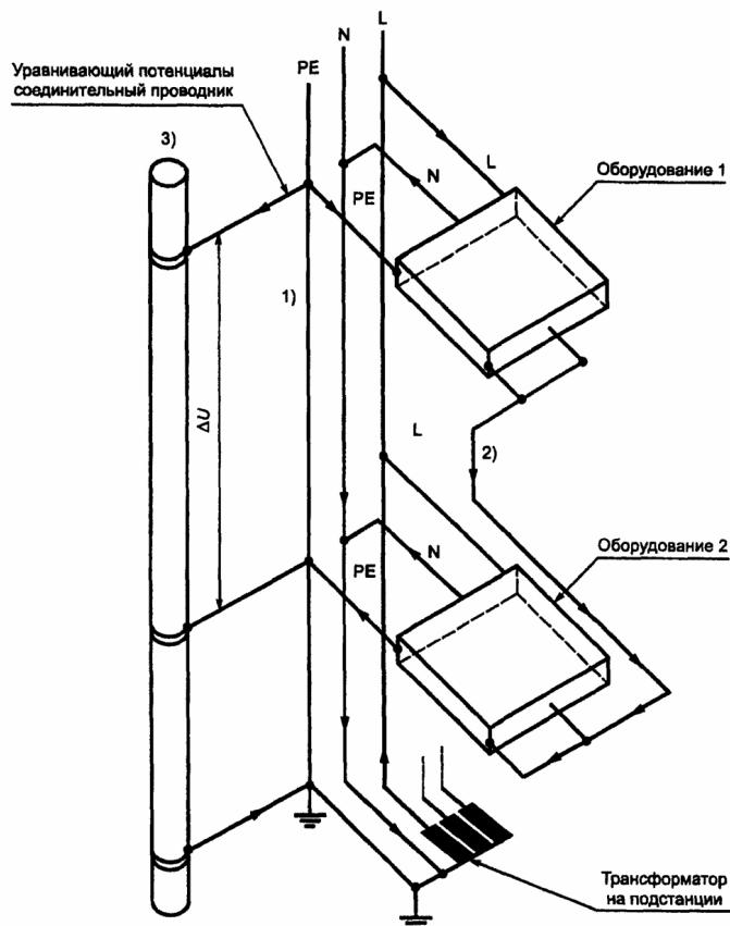
1) - устранение падения напряжения вдоль PE; 2) - соединительный проводник на ограниченной площади; 3) - металлоконструкция здания, например, труба центрального отопления
