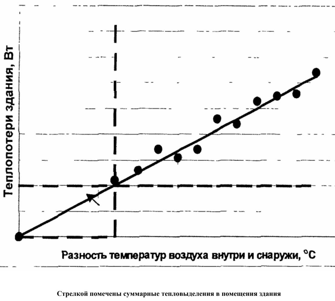
**Рисунок 1. Схема функциональной зависимости теплопотерь здания от разности температур воздуха внутри и снаружи**
