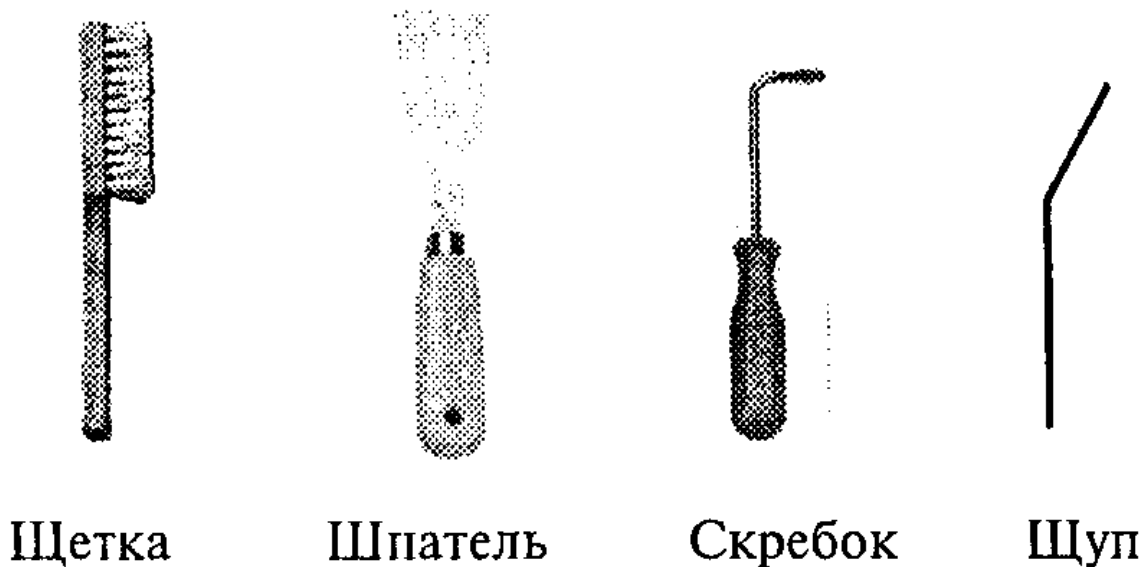
Рисунок 5.1. Комплект для монтажа труб
