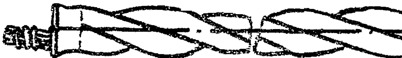
Рис. 8. Соединение проводов в овальном соединителе
