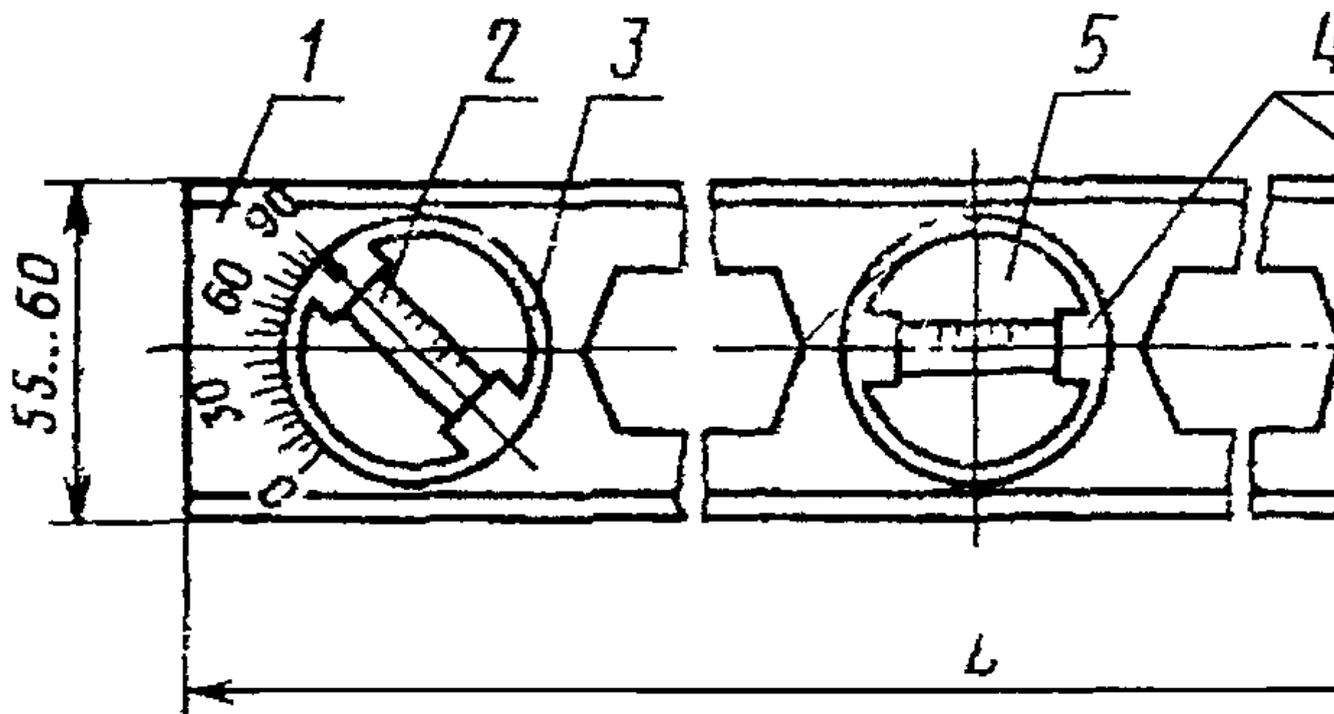
1 - корпус; 2 - ампула; 3 - блок подвижный; 4 - блок неподвижный; 5 - защитное стекло
