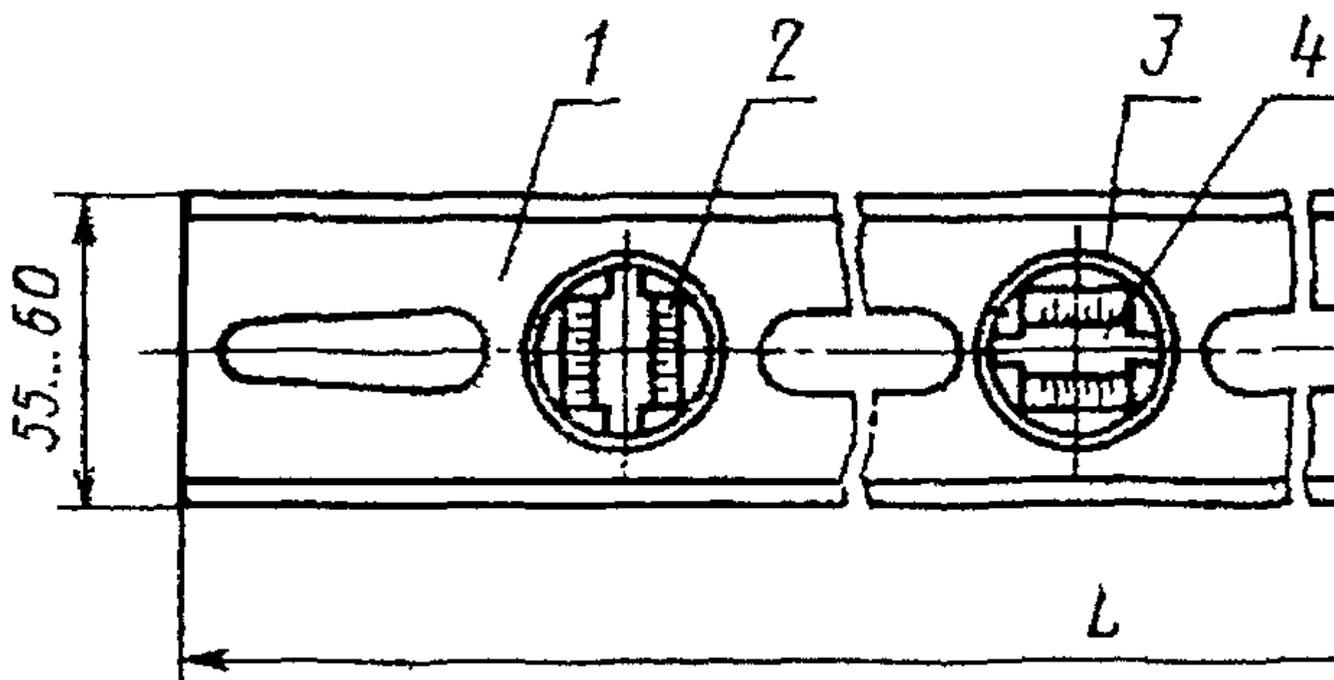
1 - корпус; 2 - ампула; 3 - блок; 4 - защитное стекло
