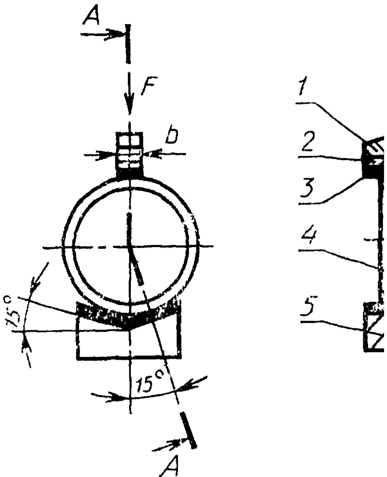
1 - деталь пресса; 2 - планка, передающая нагрузку; 3 - прокладка; 4 - образец; 5 - опора
