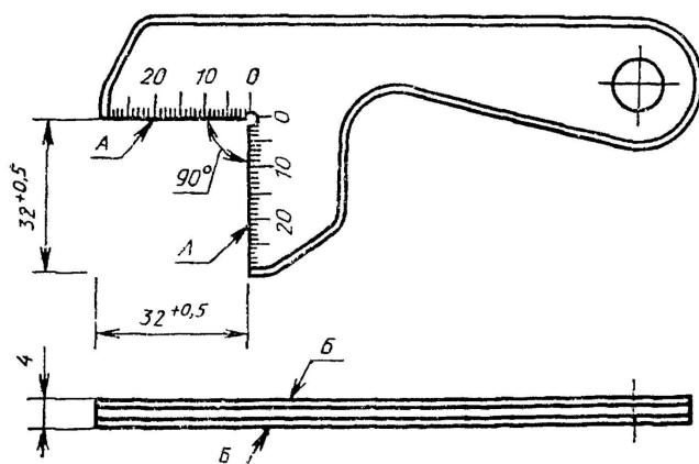
Поверхность хромирована; твердость поверхности А не менее 59 ; шкалы нанесены на обе поверхности Б
