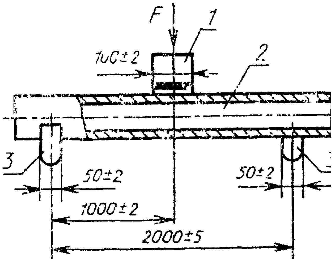
**1 - деталь, передающая нагрузку; 2 - образец; 3 - опора; 4 - прокладка
