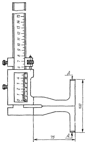
Материал - сталь инструментальная У8 ... У11 по ГОСТ 1435; поверхность хромирована; твердость поверхности А не менее 59 .
