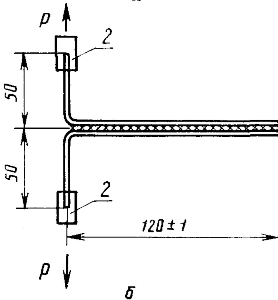
а - подложка; б - образец для испытания; 1 - площадь склеивания; 2 - захват
