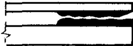
Когезионное разрушение по клею ККР
