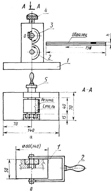
а - механическое приспособление: 1 - основание; 2 - ведущий валик диаметром 40 мм; 3 - ведомый валик диаметром 40 мм; 4 - регулировочный винт; 5 - рукоятка (привод); б - ручное приспособление: 1 - каток; 2 - ручка
