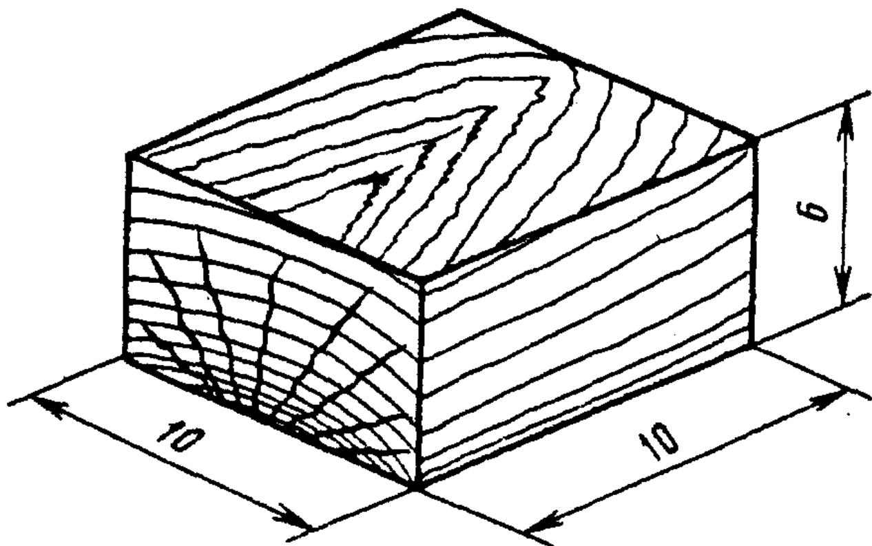
Образцы сразу после распиловки в количестве, кратном 25, помещают в конические колбы вместимостью 500 см<sup>3</sup>, заливают дистиллированной водой на 20 - 30 мм выше слоя образцов, закрывают ватной пробкой и стерилизуют в автоклаве 40 мин при (0,15 +/- 0,01) МПа. Стерилизованные образцы хранят в комнатных условиях.
