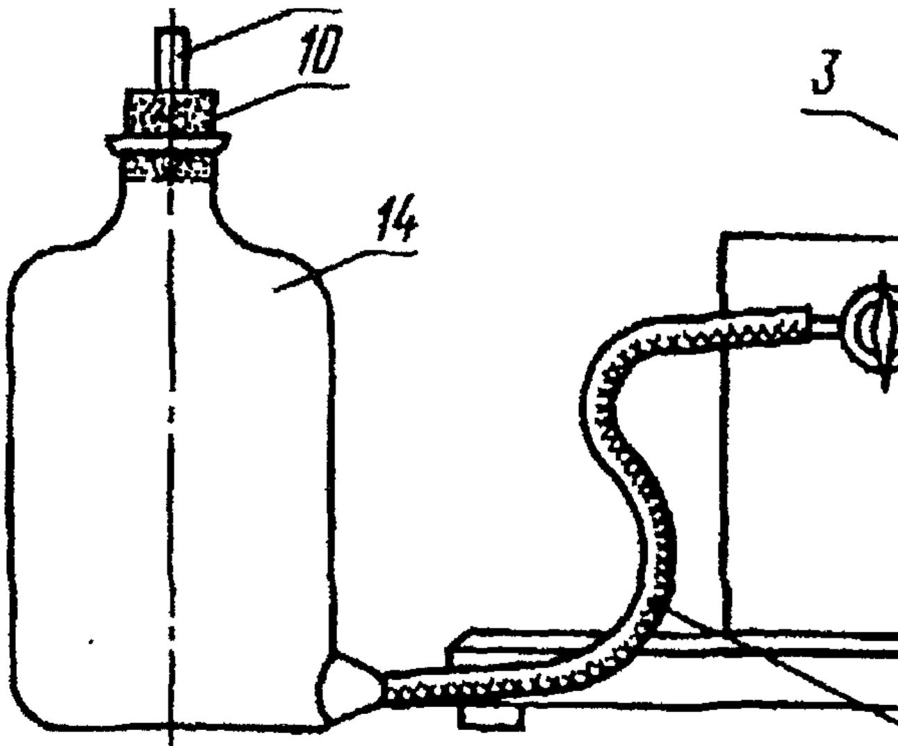
1 - цилиндр с краном; 2 - отводная трубка; 3 - клеммы для цилиндра; 4 - подставка; 5 - воронка; 6 - резиновая пробка к мантии; 7 - клемма для мантии; 8 - бюретка с краном; 9 - мантия; 10 - резиновая пробка N 20 - 22; 11 - склянка с пробиркой; 12 - пружинный зажим; 13 - соединительная резиновая трубка; 14 - склянка с тубусом; 15 - отверстие для термометра
