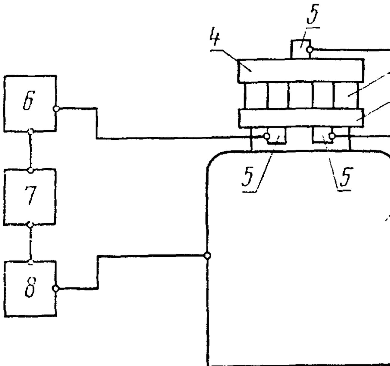
1 - электродинамический вибратор; 2 - столик вибратора; 3 - испытываемый образец; 4 - груз; 5 - акселерометры; 6 - измерительный усилитель; 7 - измерительный генератор; 8 - усилитель мощности; 9 - виброизмеритель
