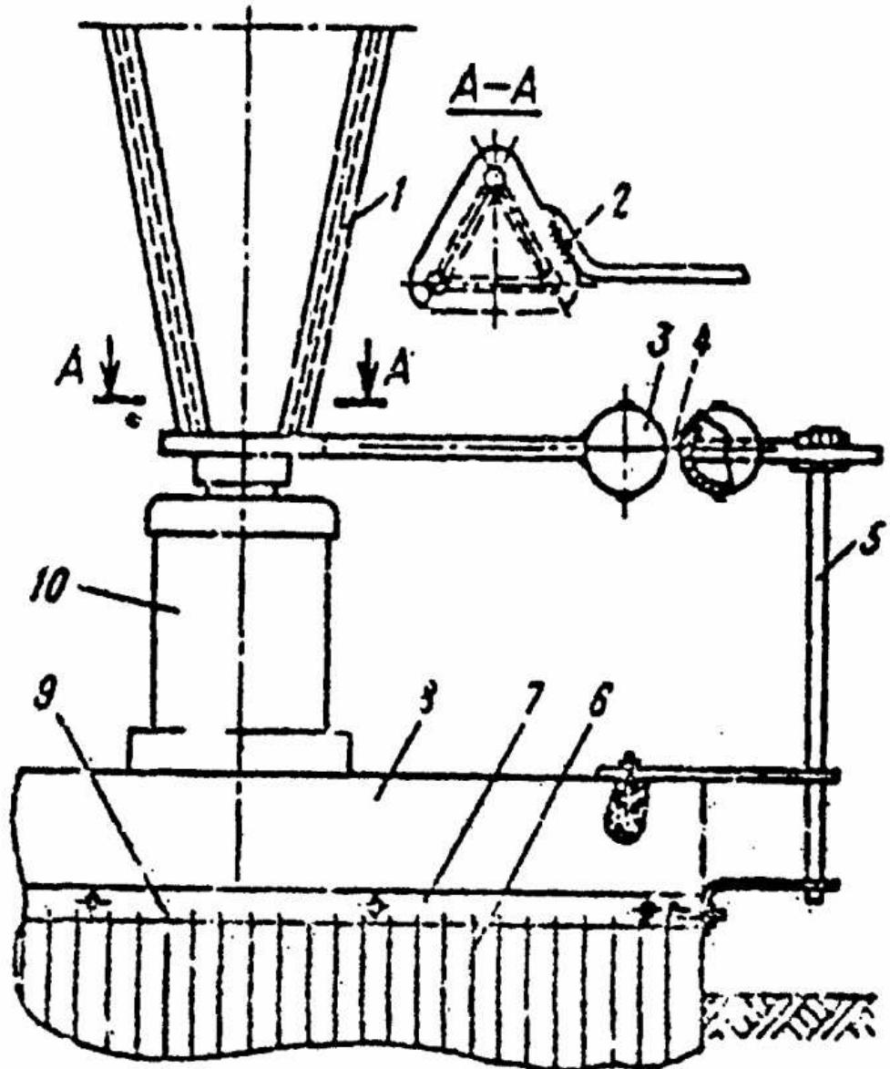
**Рис. 5. Молниезащита мачты, изолированной в основании 1 - мачта; 2 - соединение мачты с грозоразрядником сваркой латунью; 3 - грозоразрядник шаровой; 4 - искровой промежуток; 5 - стойка; 6 - лучи ВЧ заземлителя (проводка медная); 7 - шина ВЧ заземления (мединая); 8 - фундамент; 9 - соединение сваркой лучей ВЧ заземлителя с шиной ВЧ заземления; 10 - изолятор опорный.**
