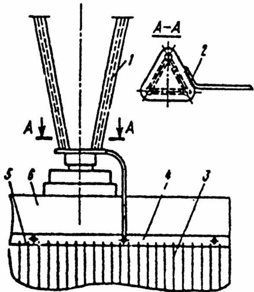
Рис. 4. Молниезащита мачты, неизолированной в основании 1 - мачта; 2 - соединение шины заземления с мачтой сваркой латунью; 3 - лучи ВЧ заземлителя (проводка медная); 4 - шина ВЧ заземления (медная); 5 - соединение лучей ВЧ заземлителя с шиной ВЧ заземления сваркой латунью; 6 - фундамент.
